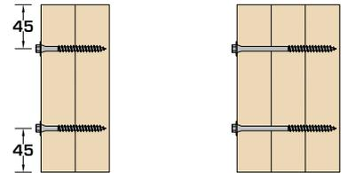
**FASTENERS CAN BE INSTALLED FROM ONE SIDE OF GIRDER TRUSS**
